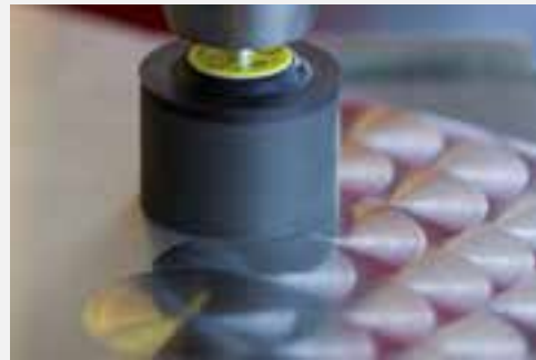
Primjer ukrasnog brušenja koristeći R-Flex element za marmoriranje SFM 656 na limu od nehrđajućeg čelika
