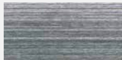
Brusna traka granulacija 40 kratke isprekidane linije, grubo obrađena površina, neravnomjeran izgled obrađene površine
