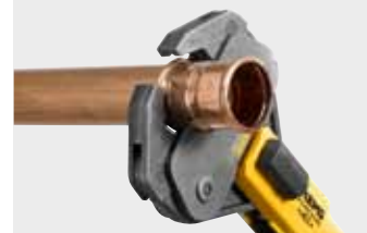
REMS kliješta za stiskanje (4G) s 2 zglobna, paralelno vođena segmenta za stiskanje za pravocrtno stiskanje spojeva srednjih dimenzija.
