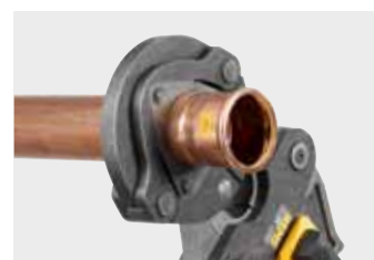
REMS prstena za stiskanje (PR) s 3 zakretljivo vođena segmenta za stiskanje, za zahtjevne spojeve stiskanjem velikih dimenzija. Optimalno stiskanje ostvareno radijalno vođenim kretanjem segmenata za stiskanje, s međukliještima.
