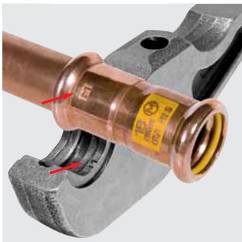
Primjer REMS kliješta za stiskanje M: Otisak "M" na stisnutom fittingu za sljedivost prema EN 1775:2007
